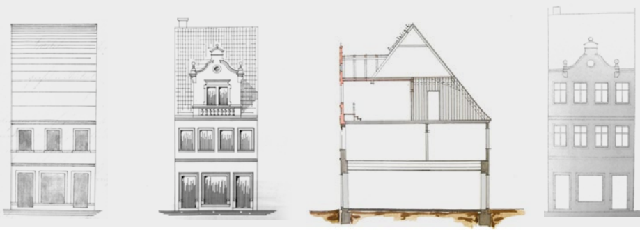
Abbildung 27: Fassadenentwicklung: 1887 Ladeneinbau, 1905 Dachgeschossausbau mit historisierendem Zwerchhausgiebel und 1934 Vollgeschoss
